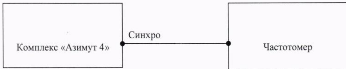
Рисунок 8 – Схема для определения погрешности следования кадровых синхроимпульсов
