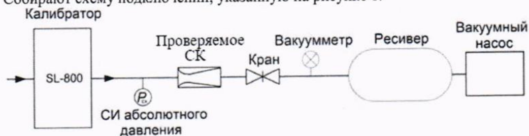
Рисунок 1 – Схема подключений СК к ЭУ-5
