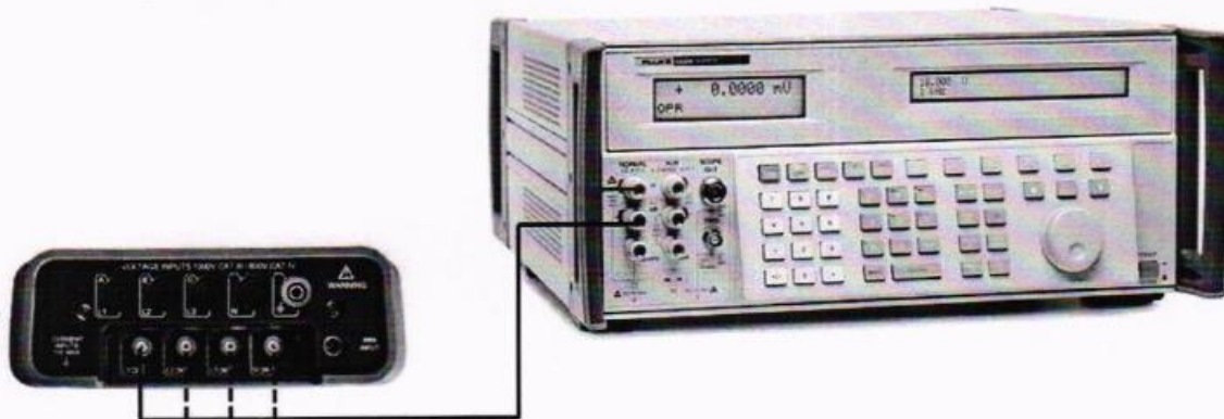
Рисунок 2 – Схема подключения приборов при определении погрешности измерения силы переменного тока без использования токовых преобразователей.
