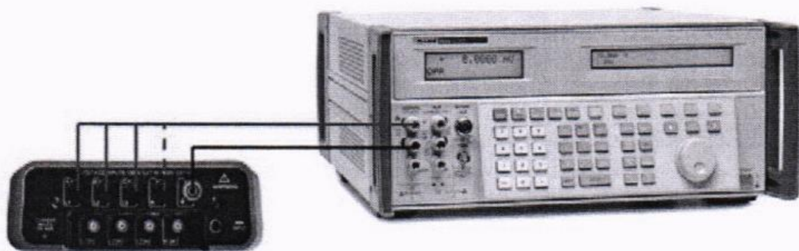
Рисунок 1 – Схема подключения приборов при определении погрешности измерения напряжения, частоты, дозы фликера
