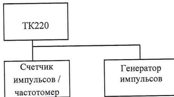
Рисунок 1 – Схема подключения генератора импульсов и частотомера
