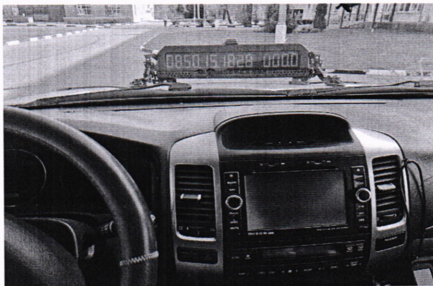
Рисунок 5 – Пример размещения «ИВС-21» на транспортном средстве
