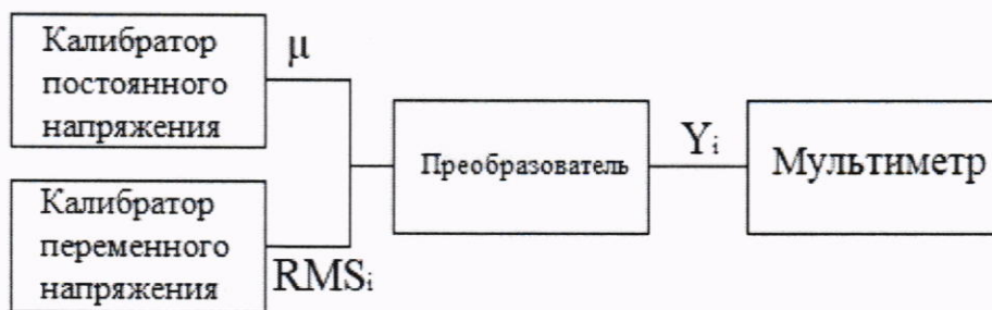
Рисунок 4 - Схема подключения для определения основной приведенной погрешности ИК, реализующих преобразование аналоговых сигналов напряжения переменного электрического тока в аналоговые сигналы напряжения переменного электрического тока
