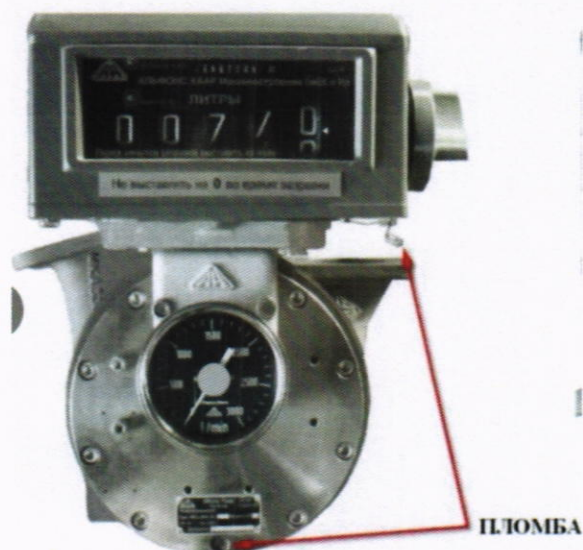
Рисунок А.2 – Схема пломбировки счётчика МКА Master
