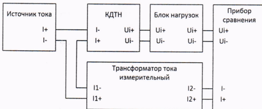
Рисунок 2 – Структурная схема определения погрешности коэффициента масштабного преобразования силы переменного тока и угловой (угла фазового сдвига) погрешности (для испытательных сигналов свыше 10А)
