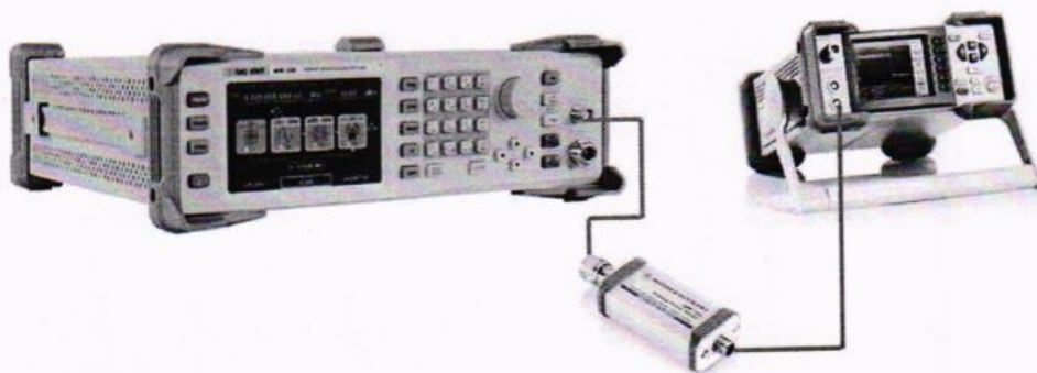
Рисунок 5 – Схема соединения приборов для определения неравномерности АЧХ встроенного НЧ генератора 10.6.5 Определить неравномерность АЧХ по формуле (8):
