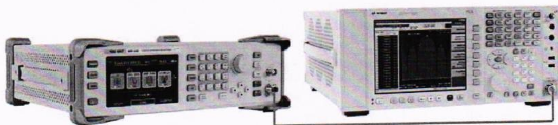
Рисунок 3 – Схема соединения приборов для определения погрешности установки выходного уровня генератора в диапазоне уровней от -30 до -110 дБм и параметров спектра
