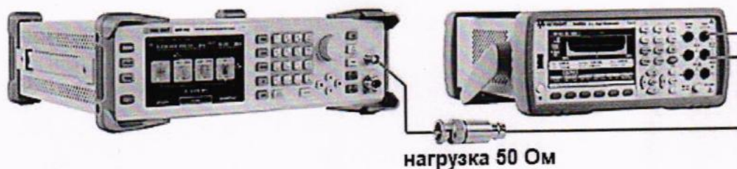
Рисунок 6 – Схема соединения приборов для определения погрешности установки уровня постоянного смещения
