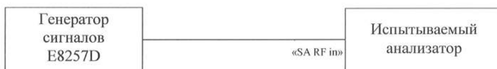
Рисунок 4 – Схема подключения для определения собственного фазового шума анализатора
