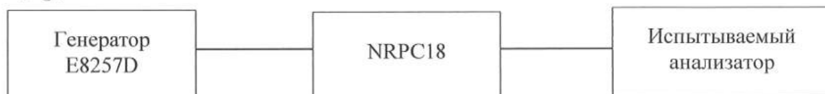
Рисунок 5 – Схема подключения для определения абсолютной погрешности измерений мощности
