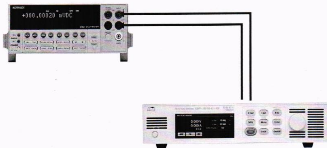
Рисунок 1 – Схема соединения приборов при определении абсолютной погрешности установки и измерений напряжения постоянного тока до 1000 В
