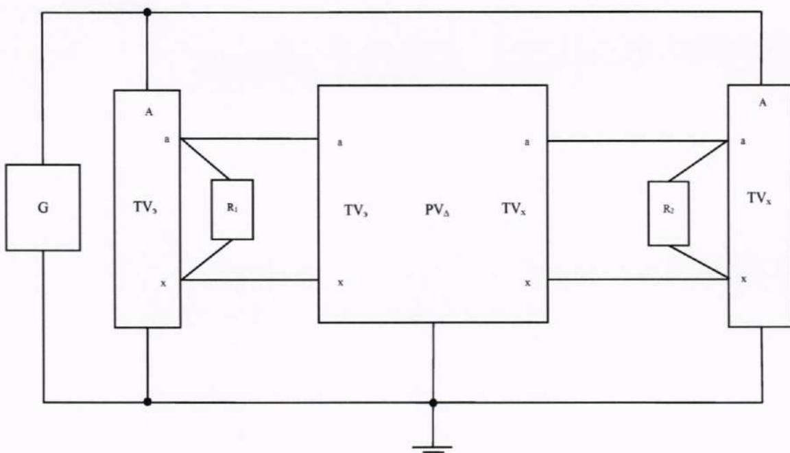
G – источник высокого напряжения;  $TV_3$  – эталонный трансформатор;  $R_1$  – нагрузочное устройство эталонного трансформатора;  $TV_x$  – поверяемый трансформатор;  $R_2$  – нагрузочное устройство поверяемого трансформатора;  $PV_\Delta$  – прибор сравнения
