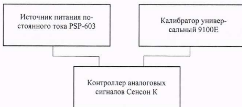
Рисунок 1 – Схема подключений для определения приведенной (к диапазону измерений) погрешности измерений силы постоянного тока
