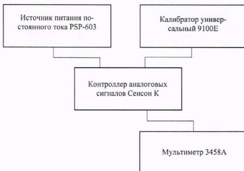
Рисунок 2 – Схема подключений для определения приведенной (к диапазону преобразований) погрешности преобразований силы постоянного тока
