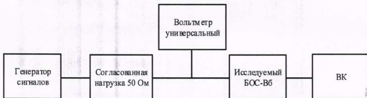
Рисунок 9.1 – Схема для определения погрешности измерений СКЗ напряжения переменного тока (параметров вибрации)
