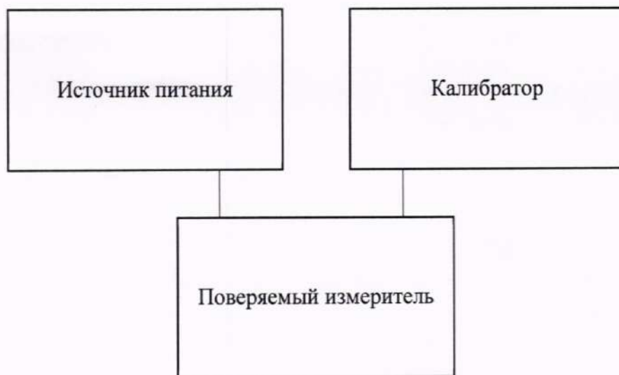
Рисунок 3 – Схема подключений для определения основной погрешности измерений сигналов силы и напряжения постоянного тока/сигналов пирометров.
