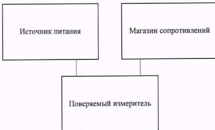
Рисунок 1 – Схема подключений для определения основной погрешности измерений сигналов ТС.
