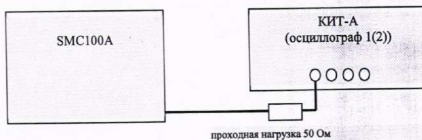
Рисунок 4 – Измерительная схема для определения полосы пропускания
