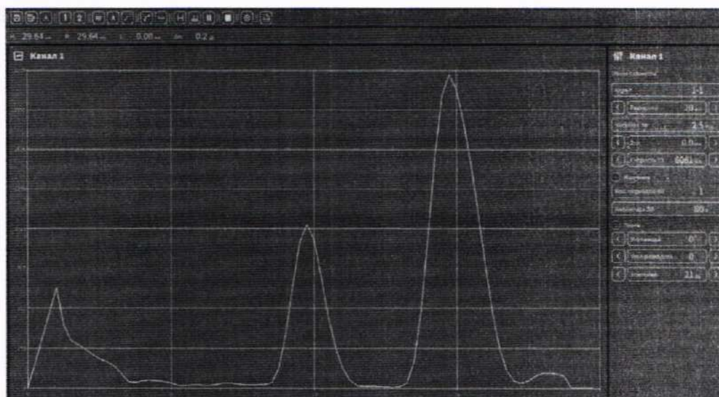
Рисунок 2 – Вид дисплея при измерении глубины залегания дефекта в мере из набора КМД-4У
