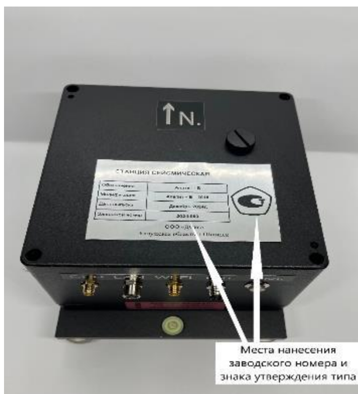
Рисунок 2 – Общий вид шильдика с указанием мест нанесения заводского номера и знака утверждения типа
