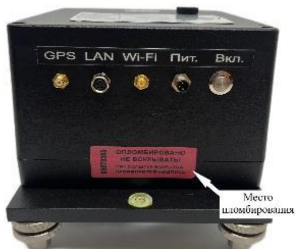
Рисунок 1 – Общий вид станции сейсмической Апатит-В и схема пломбировки от несанкционированного доступа
