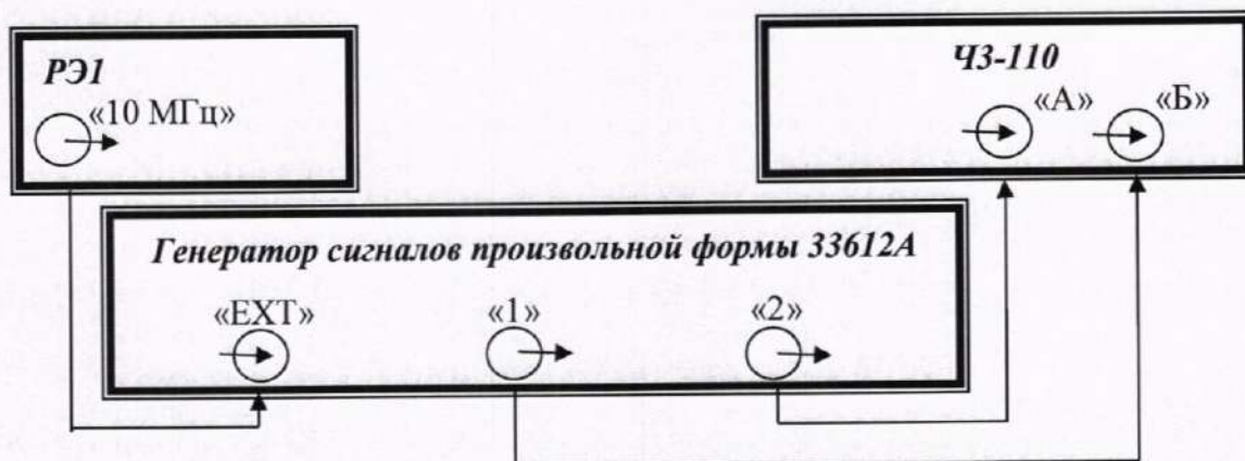
Рисунок 10 – Схема для проверки диапазона измерений разности фаз
