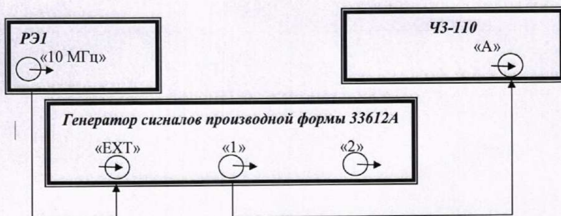
Рисунок 12 – Схема для проверки диапазона измерений количества импульсов при интервалах времени измерения от 100 мс до 2000 с
