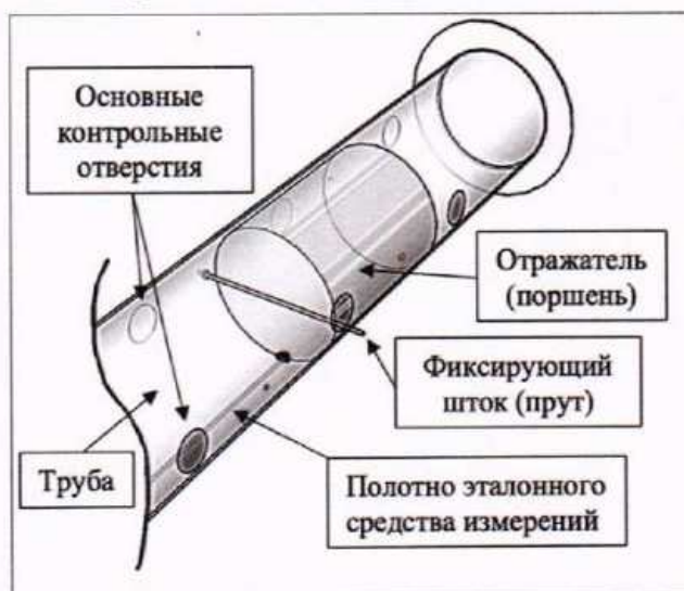
Рисунок Б.3 – Общий вид фиксации поршня
