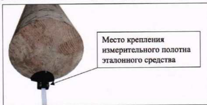
Рисунок Б.4 – Вид отражателя (поршень) с узлом крепления измерительного полотна эталонного средства
