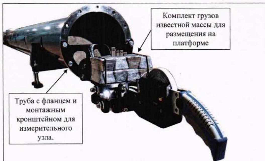
Вид смонтированного измерительного узла на трубе (показывает рабочее положение)
