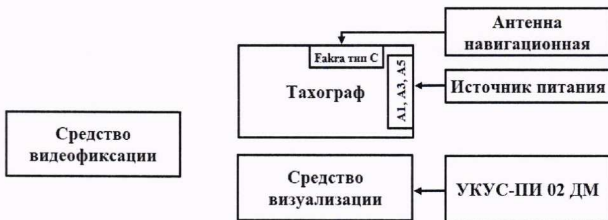
Рисунок 5 – Схема проведения измерений при определении абсолютной погрешности синхронизации шкалы времени внутреннего опорного генератора тахографа со шкалой времени блока СКЗИ
