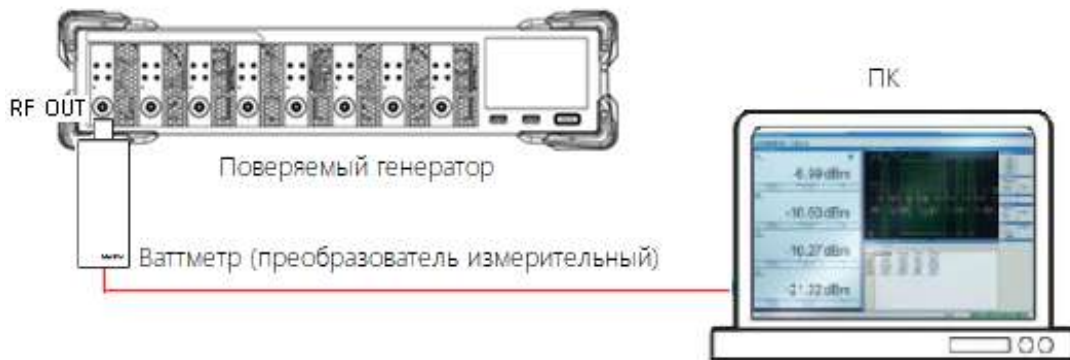
Рисунок 3 – Схема подключения приборов для определения погрешности установки уровня мощности выходного сигнала от -20 дБм до +13 дБм
