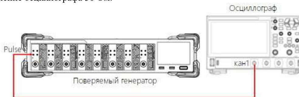
Рисунок 5 – Определение параметров выходного сигнала встроенного генератора импульсов
