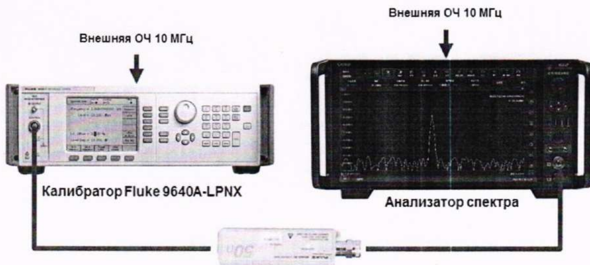
Рисунок 11. Схема соединения приборов для определения погрешности модуляции АМ, ЧМ и ФМ
