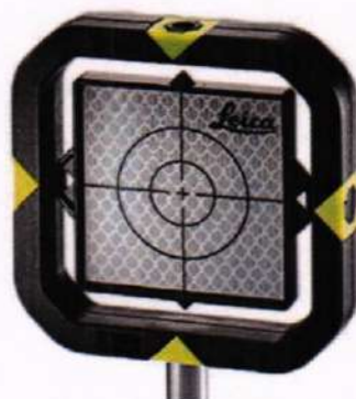
Рисунок 1 – Визирная марка для дальномера
