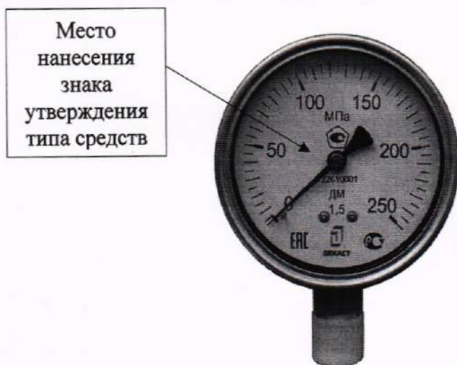
Рисунок 1 – Места нанесения знака поверки на корпус средства измерений
