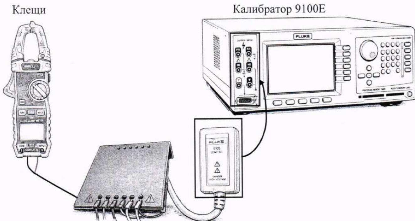
Рисунок 6 – Схема подключений для определения абсолютной погрешности измерений температуры от первичных преобразователей термоэлектрических (термопар) по ГОСТ Р 8.585-2001 типа К
