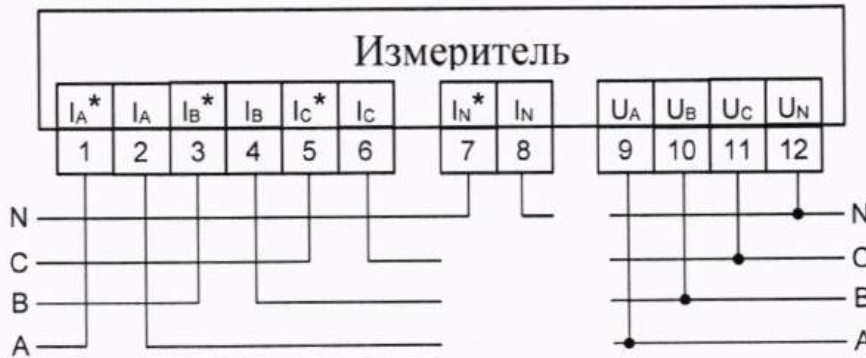
б) Схема подключений измерителей исполнений Е921ЭЛ и ЕМ120 (без измерительных трансформаторов тока, с измерением тока нейтрали)
