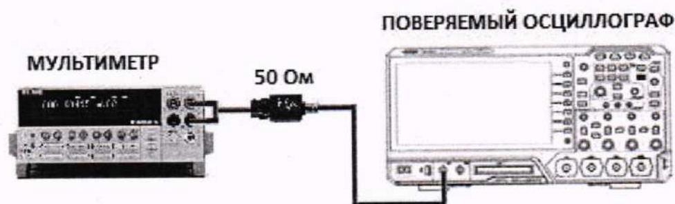
Рисунок 3 – Схема подключения оборудования для определения абсолютной погрешности установки уровня синусоидального сигнала генератора
