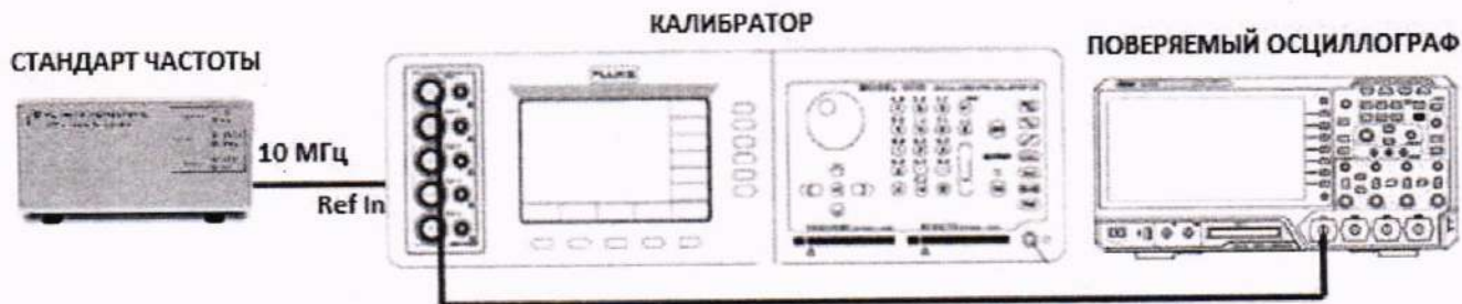
Рисунок 2 – Схема подключения оборудования для определения полосы пропускания, абсолютной погрешности измерения временных интервалов
