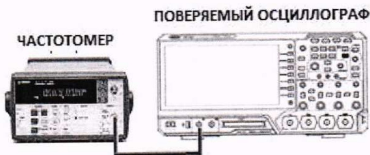
Рисунок 5 – Схема подключения оборудования при определении относительной погрешности установки частоты выходного сигнала генератора
