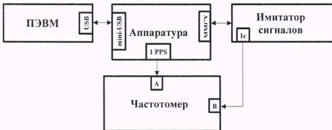
Рисунок 5 – Схема для проведения измерений при определении инструментальной погрешности синхронизации шкал времени аппаратуры
