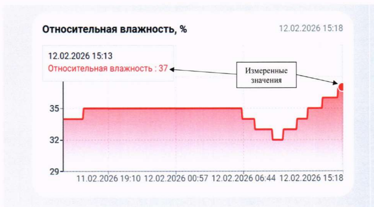
Рисунок 6 - Окно результатов измерений относительной влажности датчиком: где красная линия и красные значения – значения, измеренные внутренним датчиком
