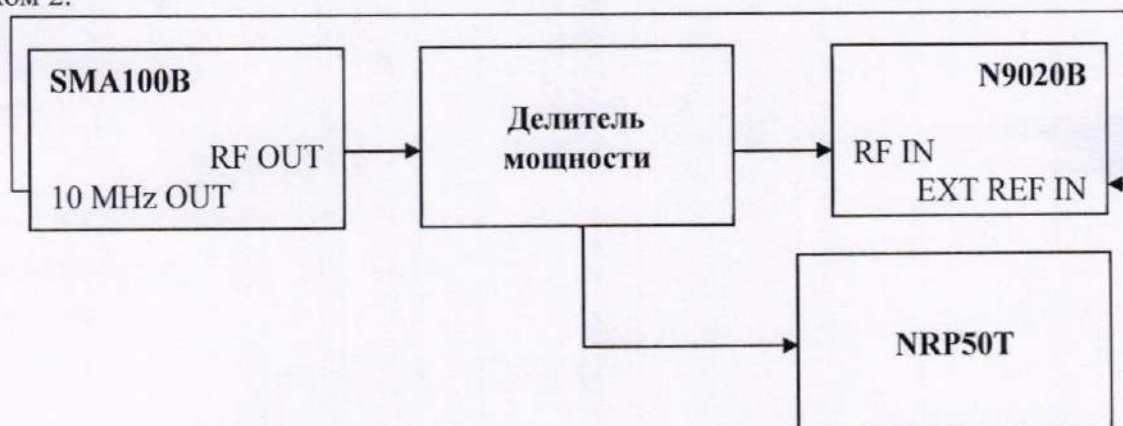
Рисунок 2 – Схема определения неравномерности АЧХ
