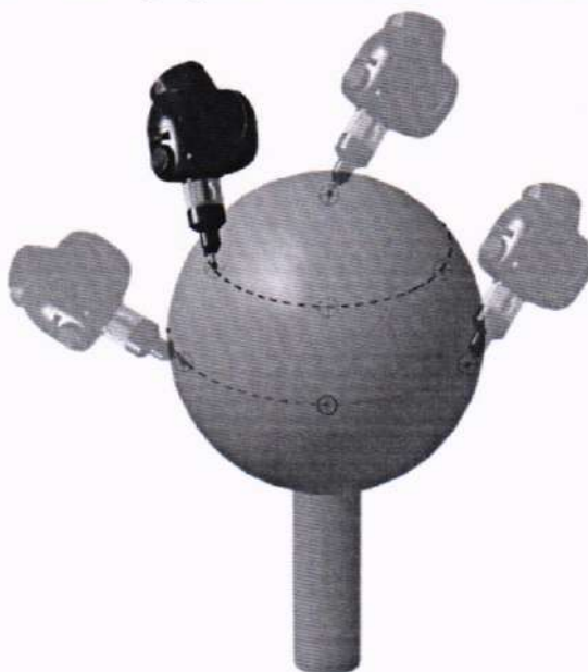
Рис.2 – Порядок определения координат центра сферы при помощи МКИП
