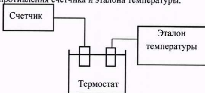
Рисунок 1 – Схема определения относительной погрешности измерения температуры
