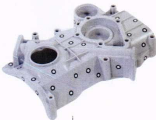
Рисунок 1 - Общий вид меток и пример их нанесения на объект сканирования.
