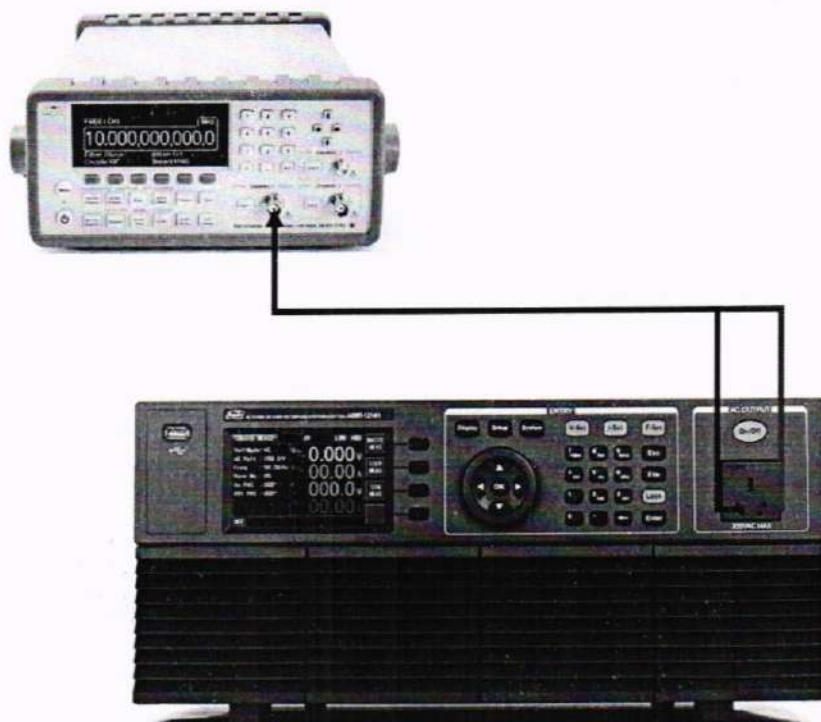
Рисунок 2- Схема соединения приборов для определения параметров частоты источников
