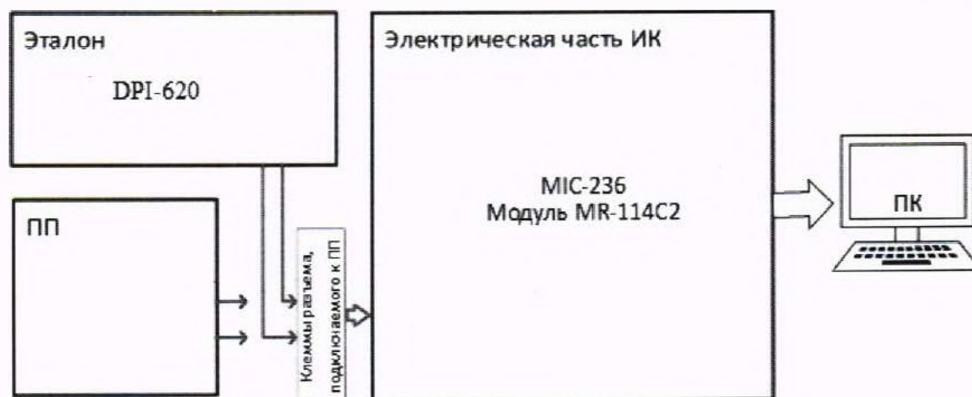
Рисунок 12 – Схема поверки ИК расхода топлива поэлементным способом
