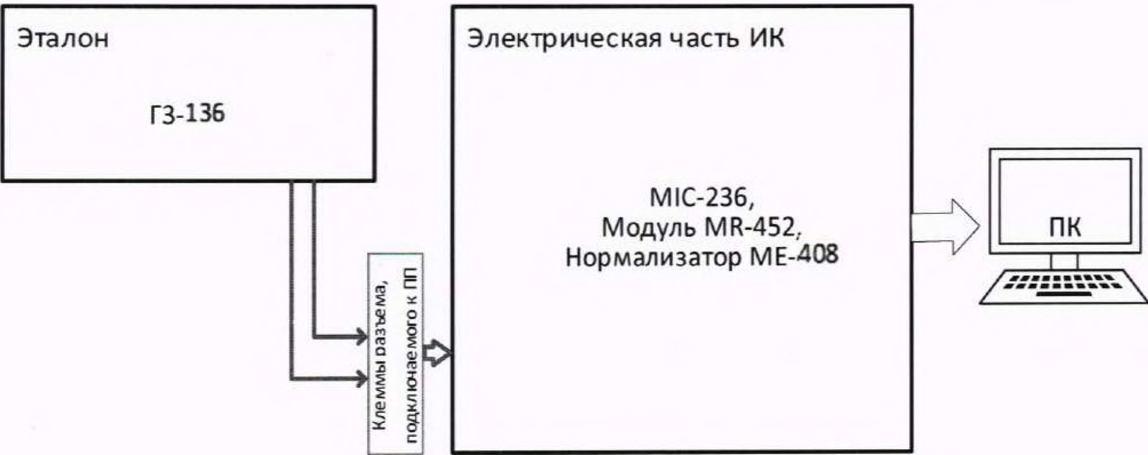
Рисунок 14 – Схема поверки ИК частоты переменного тока, соответствующей частоте вращения роторов
