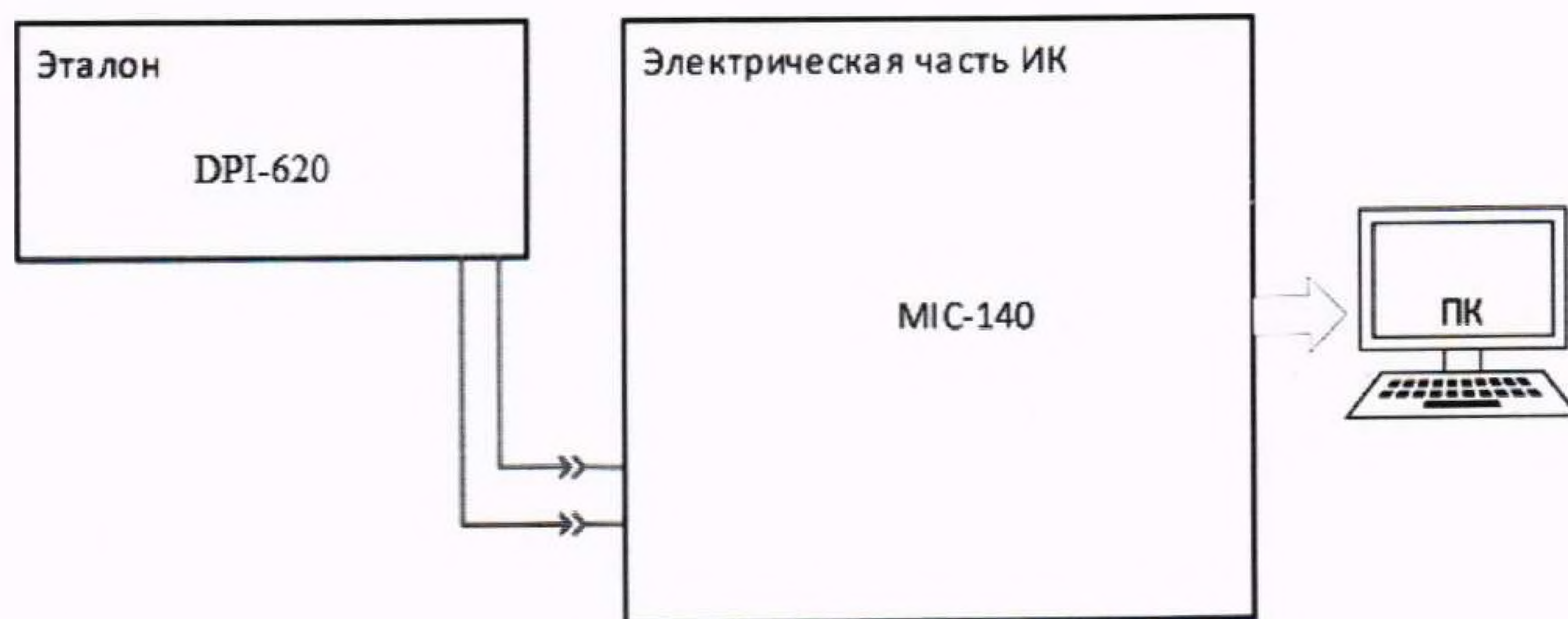
Рисунок 23 – Схема поверки напряжения постоянного тока, соответствующее значениям температуры газообразных сред, температуры корпусов и деталей в диапазоне преобразований ПП термоэлектрического типа ТХА (К), ТХК (L)
