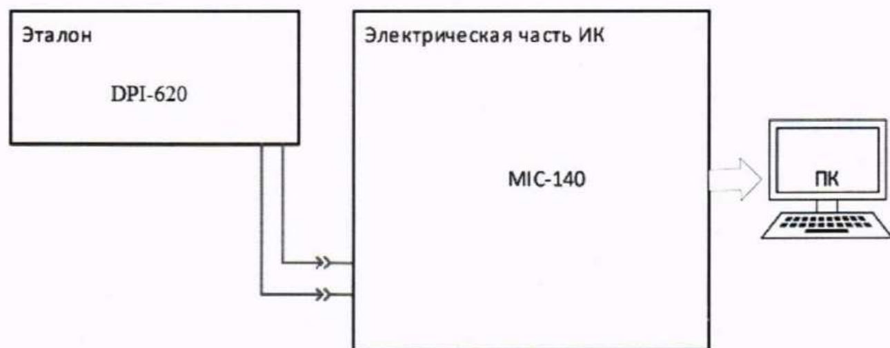
Рисунок 18 – Схема поверки напряжения постоянного тока, соответствующего значениям температуры корпусов и деталей ГТД в диапазоне преобразований ПП термоэлектрического типа ХК (L)
