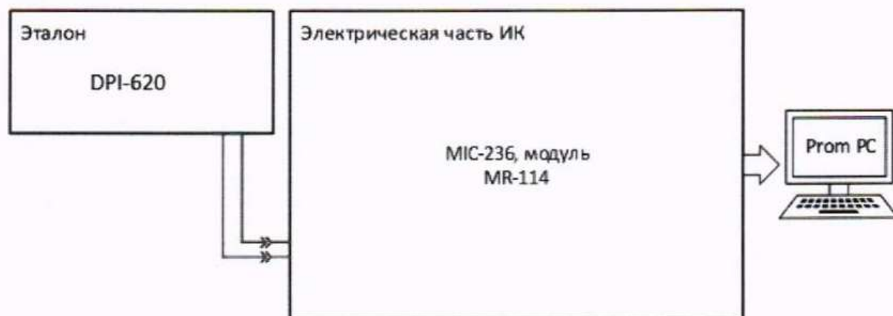
Рисунок 19 – Схема поверки электрической части ИК напряжения постоянного тока
