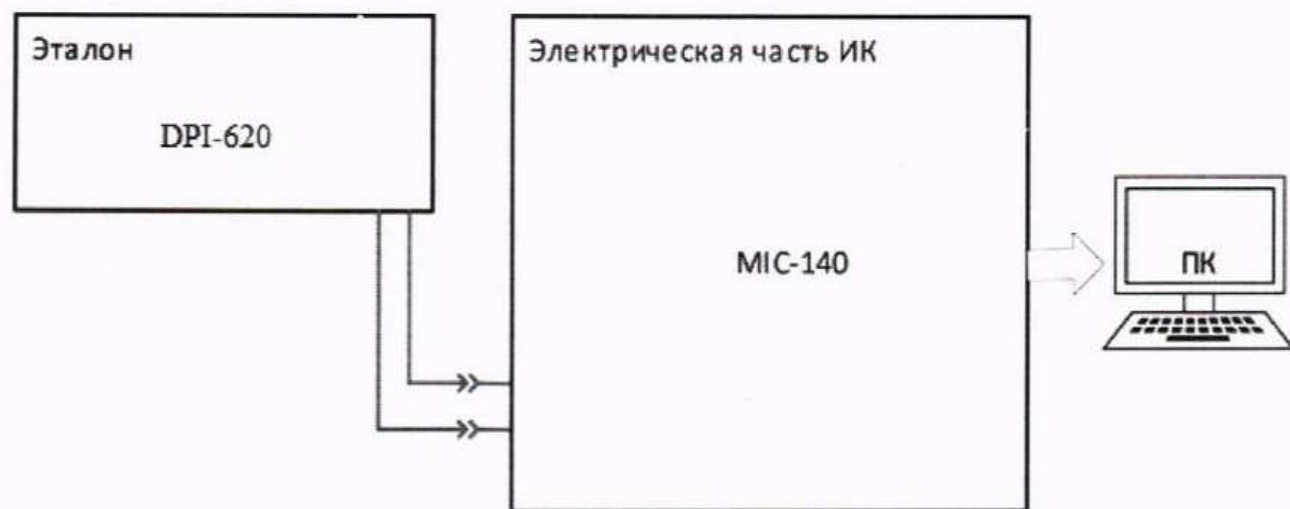
Рисунок 13 – Схема поверки напряжения постоянного тока, соответствующего значениям температуры газообразных сред в диапазоне преобразований ПП термоэлектрического типа ХА (К)
