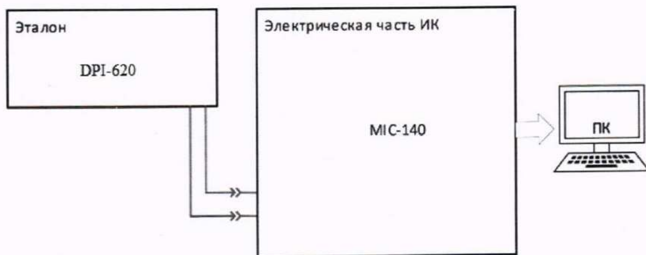
Рисунок 16 – Схема поверки напряжения постоянного тока, соответствующего значениям температуры корпусов и деталей ГТД в диапазоне преобразований ПП термоэлектрического типа ХА (К)
