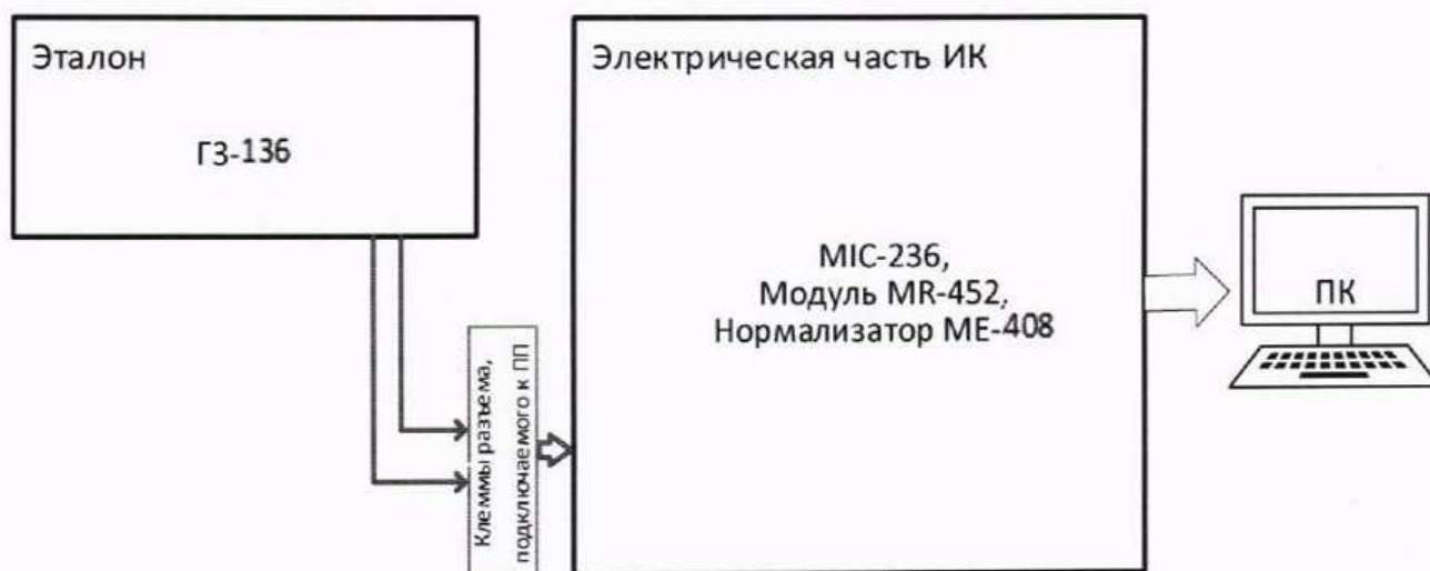
Рисунок 14 – Схема поверки ИК частоты переменного тока, соответствующей частоте вращения роторов
