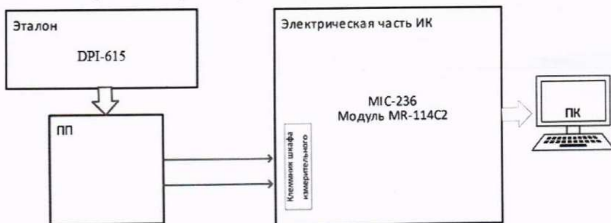
Рисунок 15 – Схема поверки ИК абсолютных, избыточных и разности давлений газообразных и жидких сред
