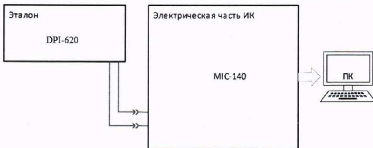
Рисунок 17 – Схема поверки ИК температуры, измеренной ПП термоэлектрического типа ХК (L)
