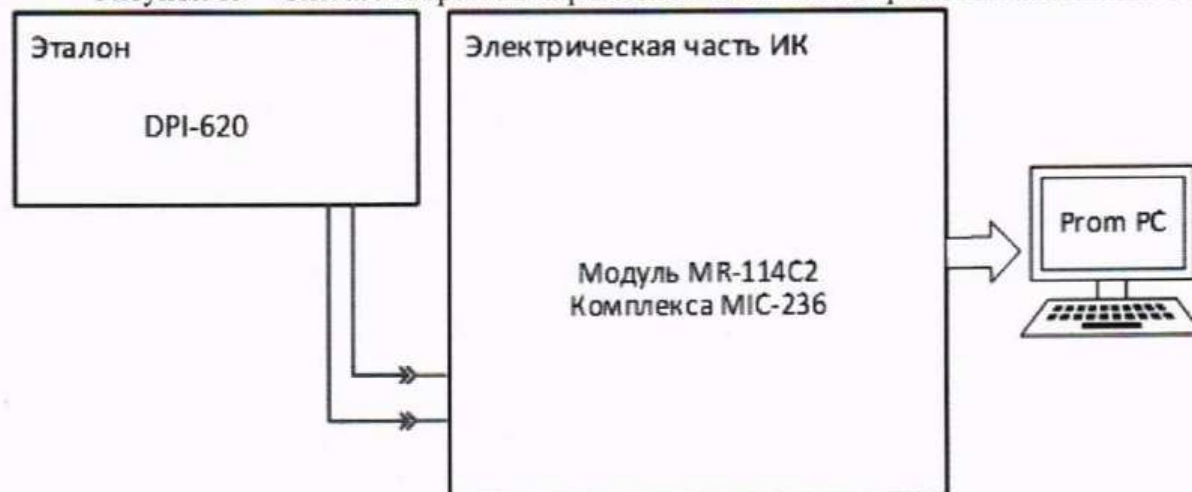
Рисунок 20 – Схема поверки электрической части ИК силы постоянного тока
