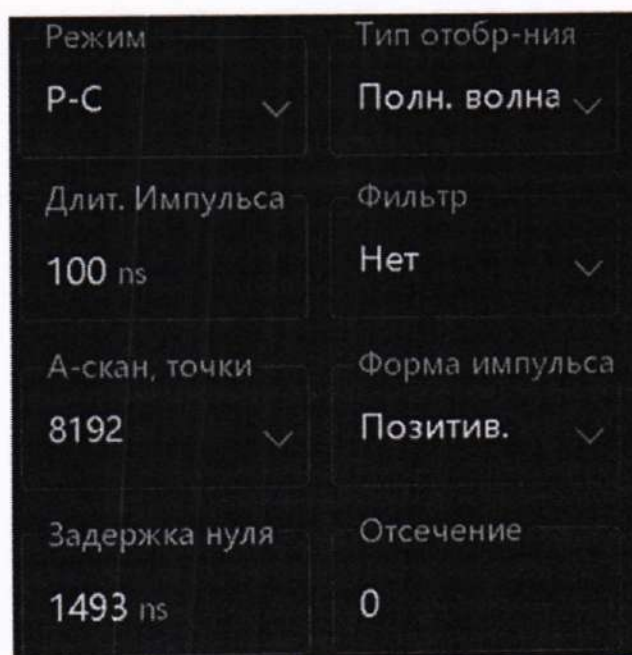
Рисунок 13 – Настройка формы импульса и задержки нуля на дефектоскопе
