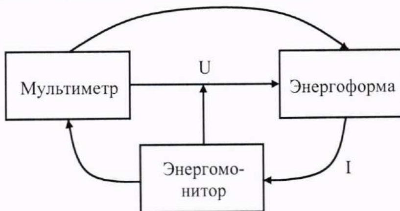
Рисунок 3 – Схема подключений для определения абсолютной погрешности измерений активной, полной мощности переменного тока
