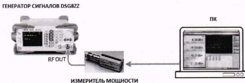
Рисунок 2 – Схема подключения приборов для определения погрешности установки уровня мощности выходного сигнала -10 дБ (1 мВт)
