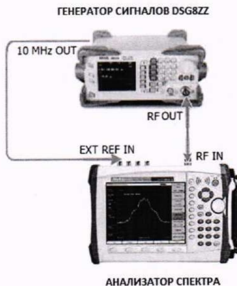
Рисунок 3 – Схема подключения приборов для определения погрешности установки уровня мощности выходного сигнала менее -10 дБ (1 мВт), определения относительного уровня гармонических и негармонических составляющих в спектре выходного сигнала, определения относительной спектральной плотности мощности фазовых шумов, определения параметров выходного сигнала в режимах амплитудной, частотной, фазовой и импульсной модуляций
