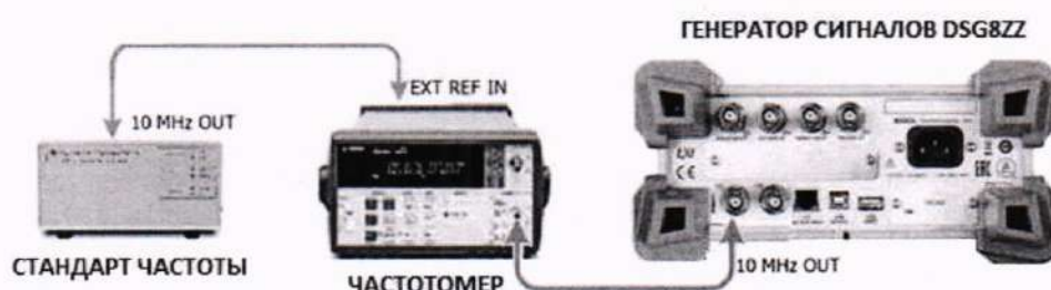
Рисунок 1 – Схема подключения приборов для определения относительной погрешности установки частоты выходного сигнала при работе от внутреннего опорного генератора
