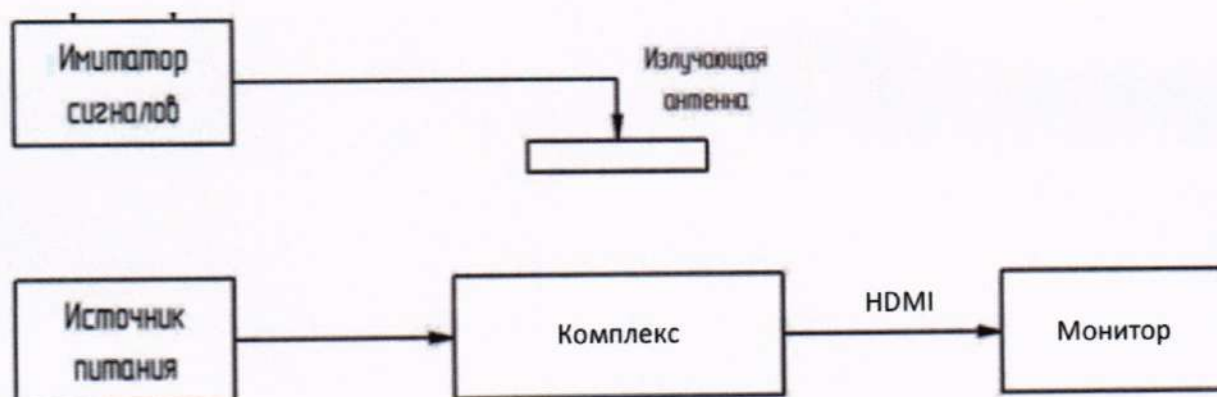
Рисунок 1. Схема подключения имитатора ГНСС к комплексу
