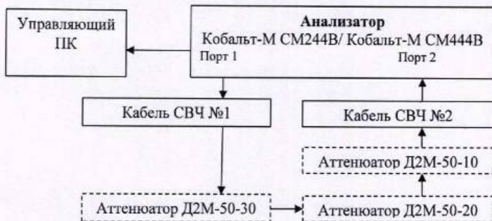
Рисунок 5 – Структурная схема соединения СИ для определения среднего квадратического отклонения значений шумов трассы ( \sigma ) при измерении коэффициента передачи в поддиапазоне частот 6 таблицы 6
