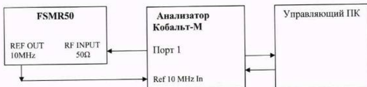
Рисунок 2 – Структурная схема соединения СИ для определения абсолютной погрешности установки уровня выходной мощности с помощью FSMR50
