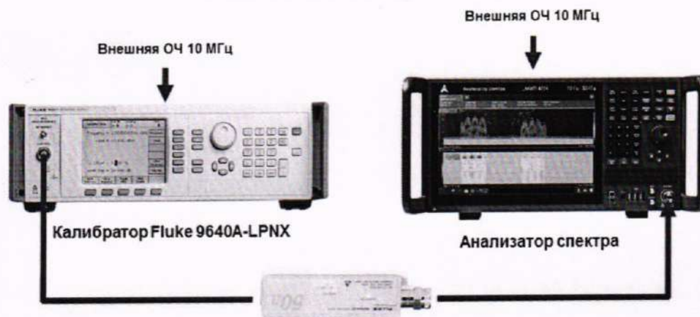
Рисунок 11 – Схема подключения при определении погрешности модуляции АМ, ЧМ и ФМ
