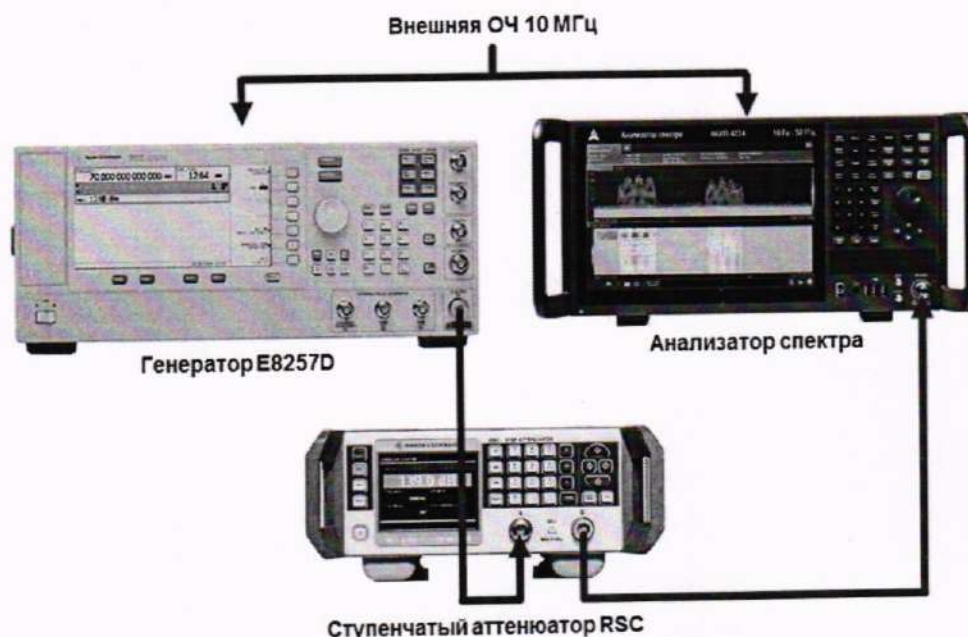
Рисунок 3 – Схема подключения при определении абсолютной погрешности установки опорного уровня в диапазоне от минус 60 до минус 10 дБм.
