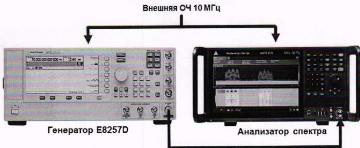
Рисунок 4 – Схема подключения при определении погрешности измерения уровня при переключении аттенюатора относительно 10 дБ.
