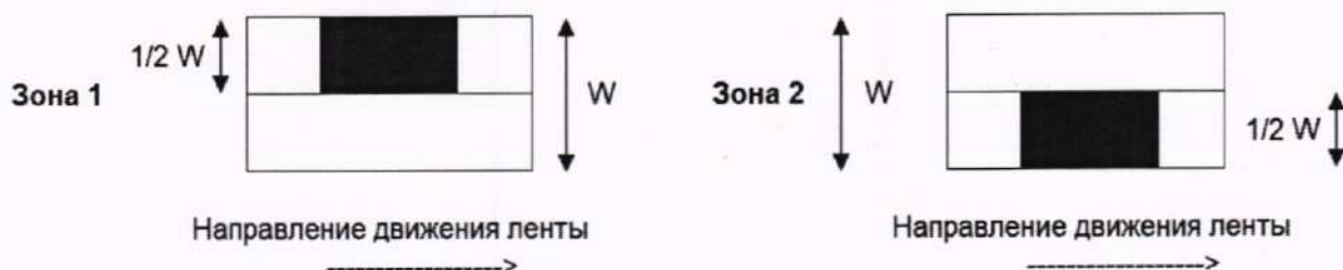
Рисунок 1 – Расположение испытательных нагрузок при оценке погрешности в автоматическом режиме взвешивания объектов измерений при их нецентрированном положении при движении по конвейерной ленте
