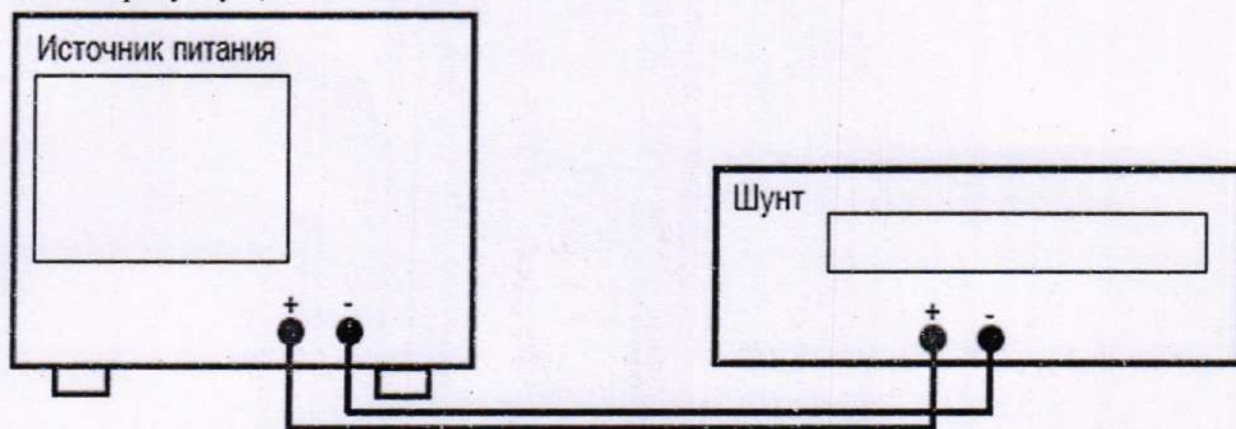
Рисунок 3 – Схема подключения источника при определении абсолютной погрешности воспроизведений силы постоянного тока
