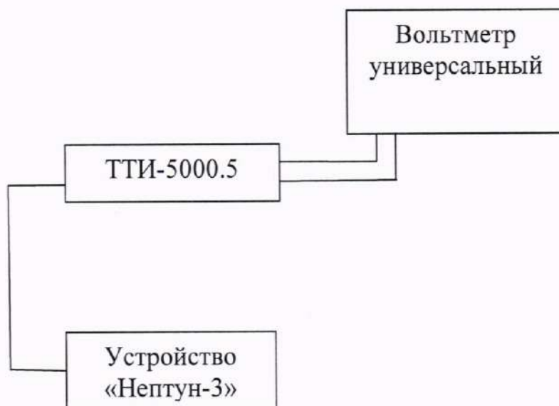
Рисунок 1 – Схема испытаний при измерении силы переменного тока 100 А (канал 1)
