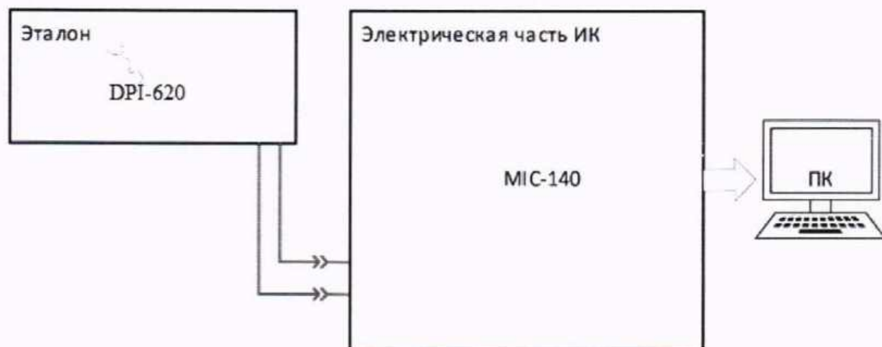
Рисунок 25 – Схема поверки напряжения постоянного тока, соответствующее значениям температуры газообразных сред, температуры корпусов и деталей в диапазоне преобразований ПП термоэлектрического типа ТХА (К), ТХК (L)
