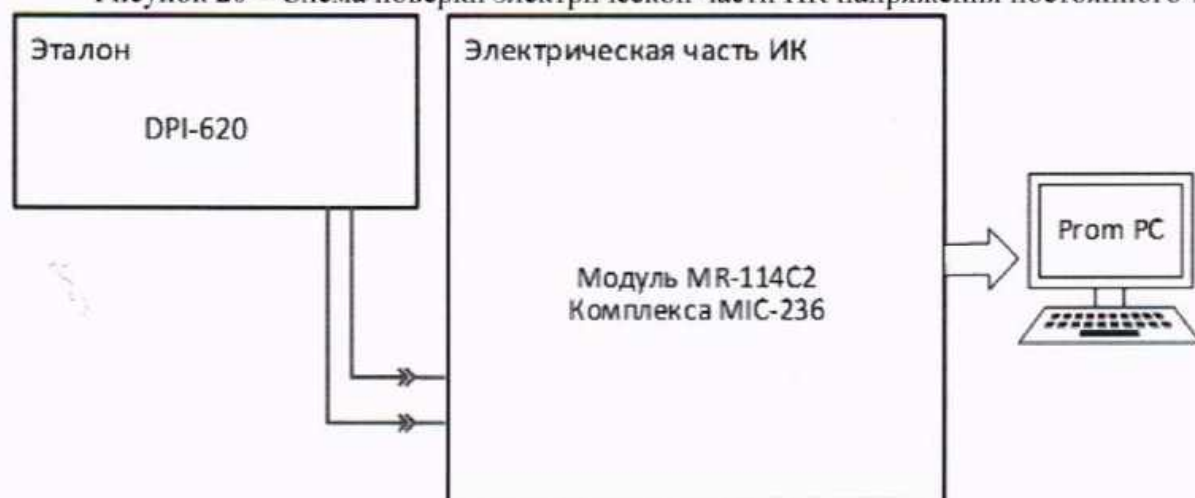
Рисунок 21 – Схема поверки электрической части ИК силы постоянного тока
