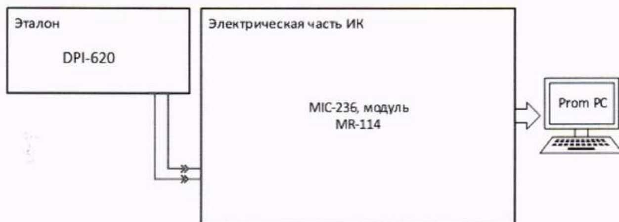
Рисунок 20 – Схема поверки электрической части ИК напряжения постоянного тока
