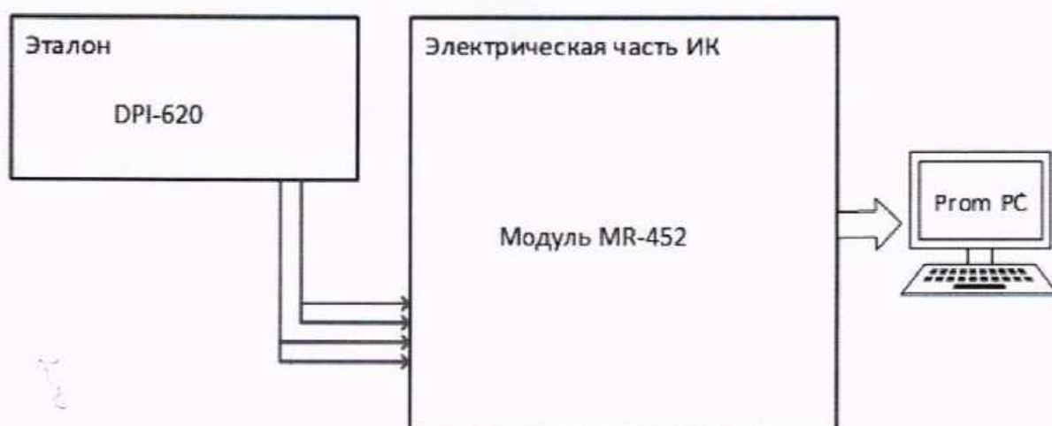
Рисунок 23 – Схема поверки электрической части ИК частоты переменного тока
