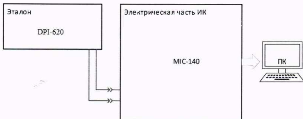
Рисунок 16 – Схема поверки напряжения постоянного тока, соответствующего значениям температуры газообразных сред в диапазоне преобразований ПП термоэлектрического типа ТХК (L)
