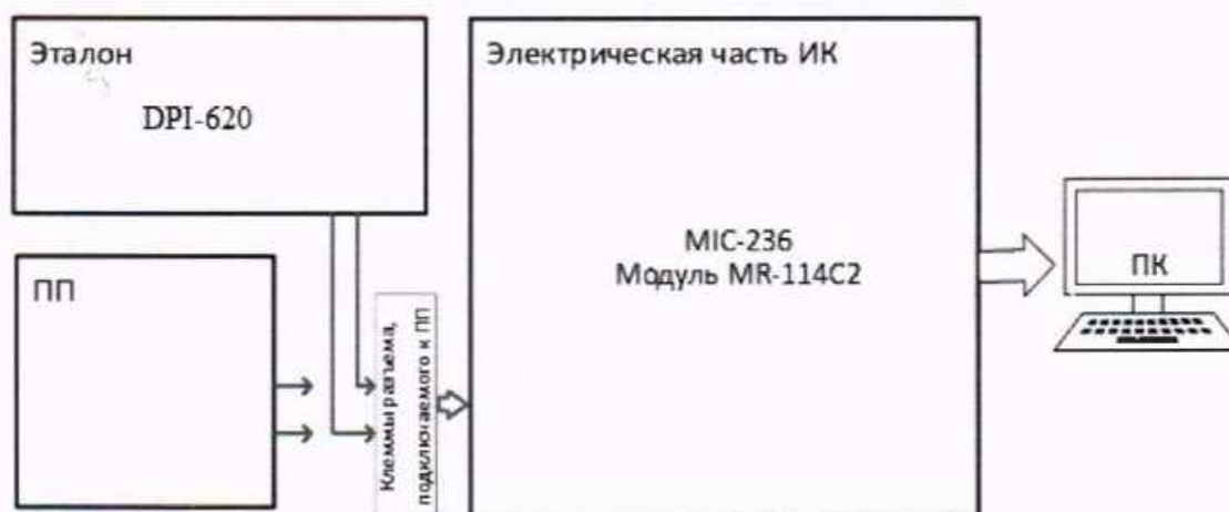
Рисунок 12 – Схема поверки ИК расхода топлива поэлементным способом
