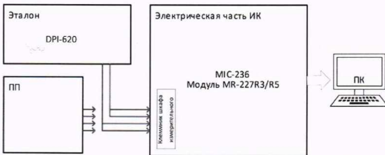
Рисунок 19 – Схема поверки ИК температуры в диапазоне преобразований ПП терморезистивного типа (термометров сопротивления)
