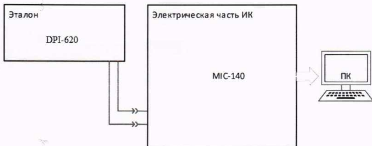
Рисунок 18 – Схема поверки ИК температуры, измеренной ПП термоэлектрического типа ТХК (L)
