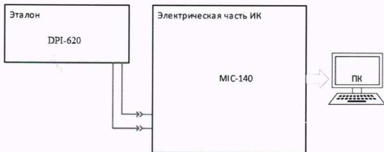
Рисунок 13 – Схема поверки напряжения постоянного тока, соответствующего значениям температуры газообразных сред в диапазоне преобразований ПП термоэлектрического типа ТХА (К)
