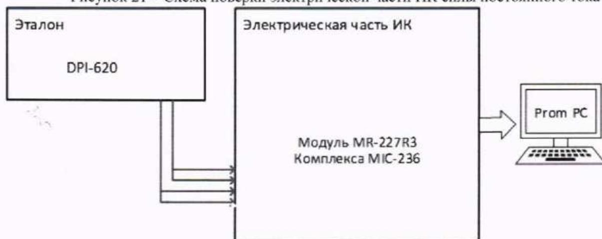
Рисунок 22 – Схема поверки электрической части ИК сопротивления постоянному току
