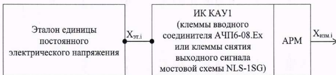
Рисунок 2 - Схема подключений при определении приведенной погрешности измерительных каналов при преобразовании постоянного электрического напряжения
