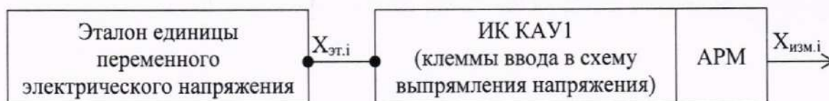
Рисунок 3 - Схема подключений при определении приведенной погрешности измерительных каналов при преобразовании переменного электрического напряжения
