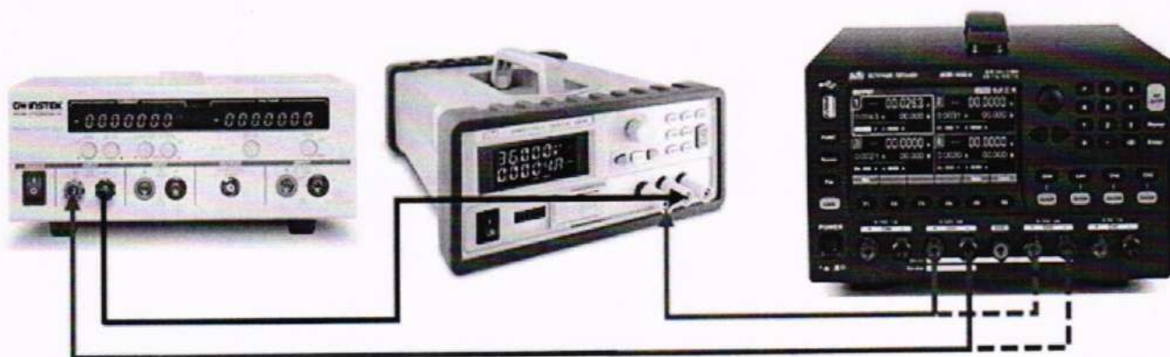
Рисунок 7 - Схема соединения приборов при определении абсолютной погрешности установки и измерения силы постоянного тока при работе в режиме стабилизации тока (режим электронной нагрузки)
