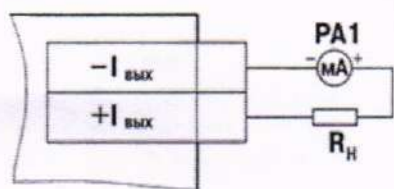
а) Схема для проверки выходных сигналов силы постоянного тока с использованием встроенного ИП;
